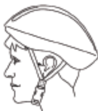
Incorrecto Frente expuesta
